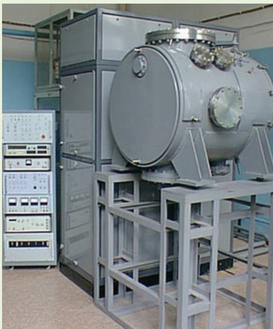
Установка с гиротроном до 30 кВт
