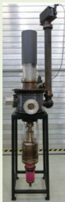
Одномегаваттные гиротроны со ступенчатой перестройкой частоты диапазона D, в которых используются 40-амперные МИП разработки ИПФ / ГИКОМ / KIT
