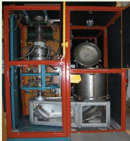
Гиротронный комплекс компании ГИКОМ для обработки материалов на 10–15 кВт / 30 ГГц
