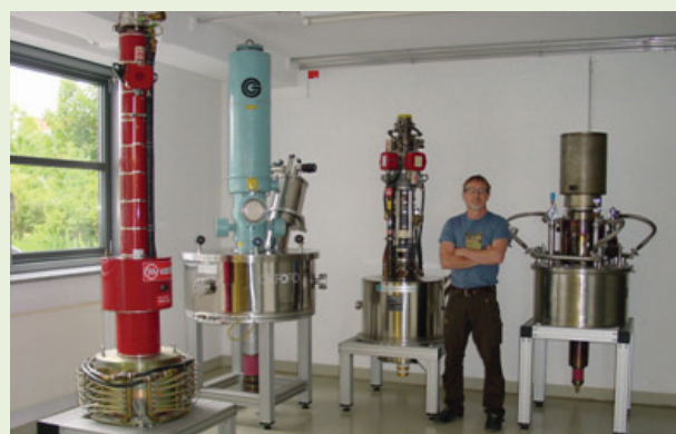
Зал славы гиротронов в IPP-Greifswald. Гиротроны, слева направо: VARIAN, 20 ГГц / 0,2 MBm, непр. режим; ГИКОМ, 140 ГГц / 0,5 MBm / 3 с; VARIAN, 70 ГГц / 0,2 MBm / 0,1 с; «Салют», 140 ГГц / 0,8 MBm / 1 с
