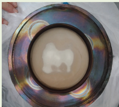
Борнитридное выходное окно «Наташи» с тенью уширенного ВЧ-пучка. Можно поиграть в фазовую игру Григория Денисова, опознавая животное по силуэту и превращая его в другое животное с помощью фазосдвигающих зеркал
